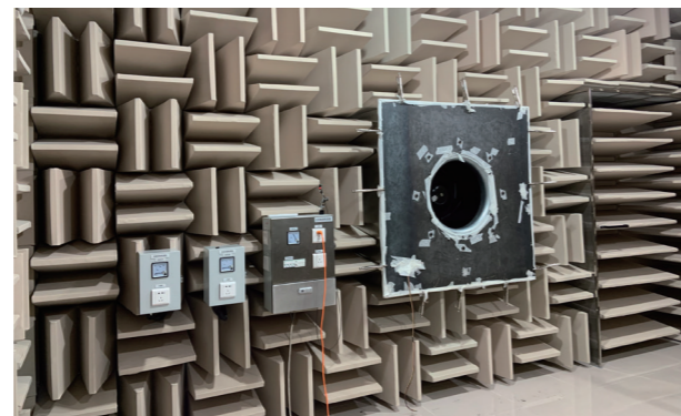
风机噪声测试消音室 Fan noise test anechoic chamber
